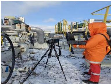
Обнаружение утечек осуществляется с помощью OGI камеры EyeCGas 2.0 и программного обеспечения EyeCSite® для обнаружения и количественной оценки утечек газа.
